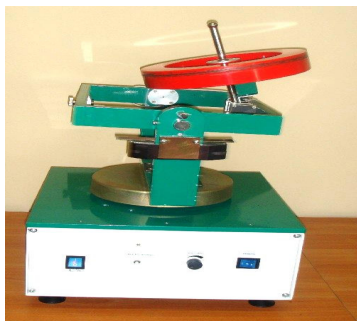
Рисунок 2 – Общий вид и схема экспериментальной установки «Двухступенной гироскоп»
