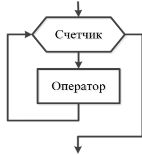
Рисунок 4.3 – Цикл с известным числом повторений
