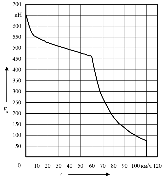
Рисунок В.12 – Тяговая характеристика электровоза ВЛ82
