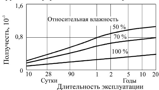
Рисунок 1 – Влияние влажности среды на ползучесть бетона [6]
