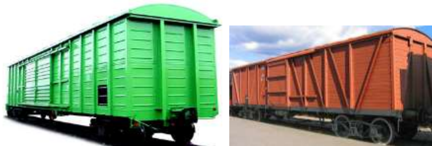
Рисунок 3.1 – Общий вид универсального четырехосного крытого вагона
