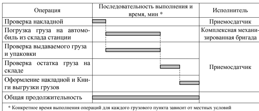
Рисунок 10.3 – Технологический график выдачи груза из склада станции
