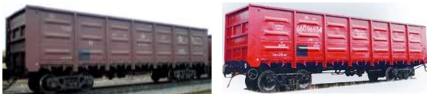
Рисунок 3.3 – Общий вид универсального четырехосного полувагона с глухими торцовыми бортами
