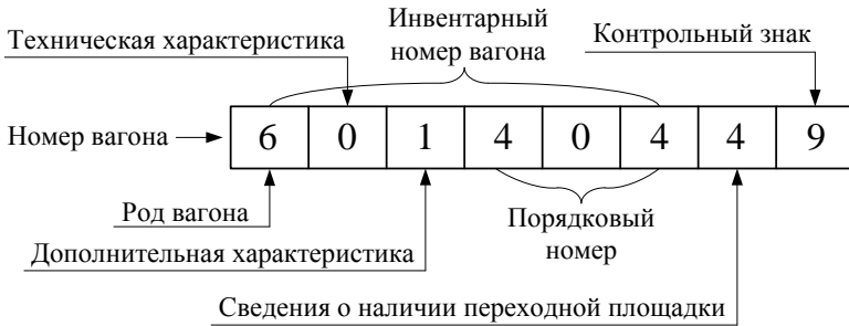
Рисунок 3.6 – Структура построения номера вагона
