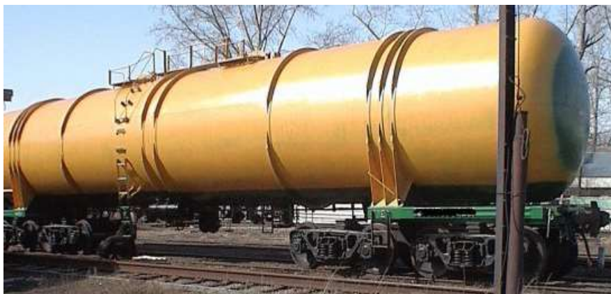
Рисунок 3.4 – Общий вид восьмиосной цистерны для перевозки нефтепродуктов
