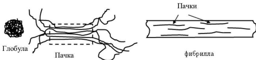
Рисунок 5.5 – Элементы надмолекулярной структуры аморфных полимеров
