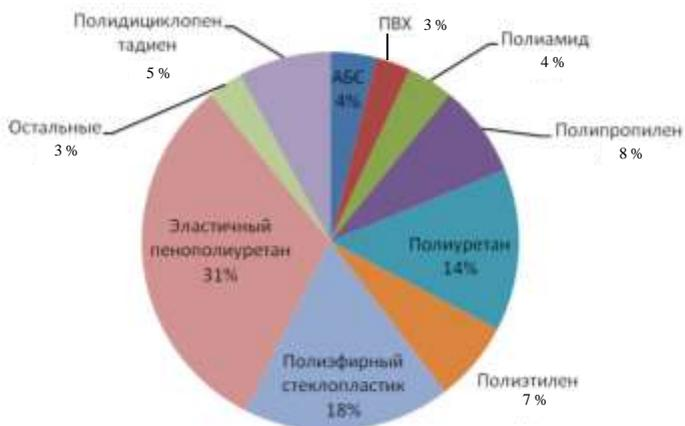
Рисунок 5.8 – Распределение полимерных материалов, используемых для сборки автомобилей КамАЗ
