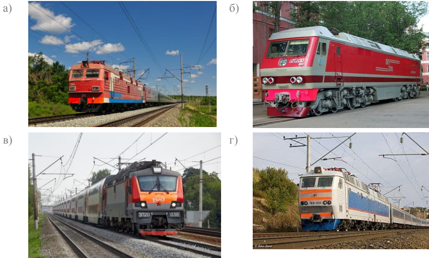
Рисунок 4.34 – Магистральные пассажирские электровозы переменного тока: а – шестиосный односекционный; б – восьмиосный односекционный скоростной (до 200 км/ч); в – двухсистемный скоростной; г – восьмиосный двухсекционный (до 140 км/ч)
