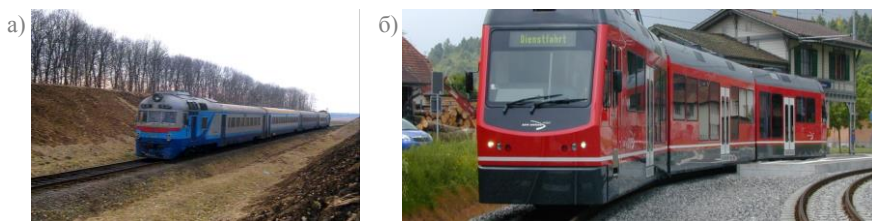
Рисунок 4.45 – Дизель-поезда модульного типа: а – с головными мотор-вагонами; б – со всеми мотор-вагонами
