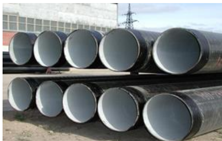
Рисунок 6.12 – Внешний вид труб с внутренним цементно-песчаным покрытием
