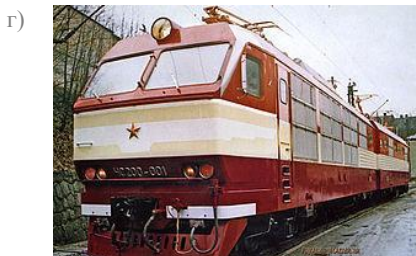
Рисунок 4.33 – Магистральные пассажирские электровозы постоянного тока: а – шестиосный односекционный; б – восьмиосный двухсекционный скоростной (до 160 км/ч); в – односекционный скоростной; г – восьмиосный двухсекционный скоростной (до 200 км/ч)
