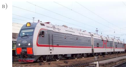
Рисунок 4.32 – Магистральные грузовые электровозы переменного тока: а – шестиосный односекционный; б – восьмиосный двухсекционный повышенной мощности; в – двенадцатиосный трехсекционный; г – шестнадцатиосный четырехсекционный
