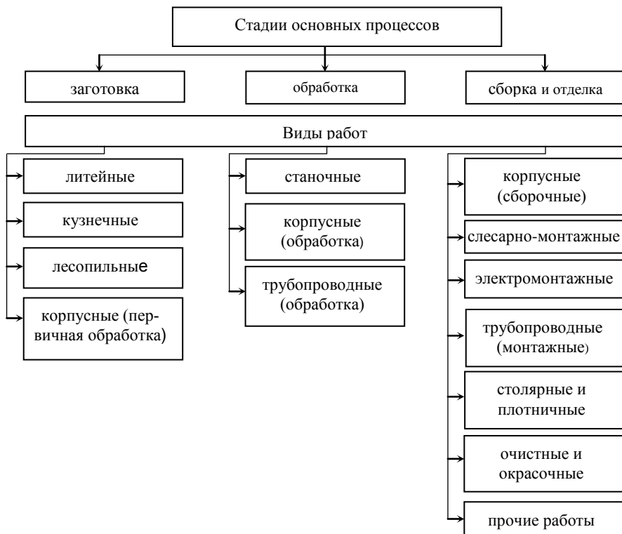
Рисунок 5.48 – Структура основных процессов и видов работ судоремонтных и судостроительных предприятий
