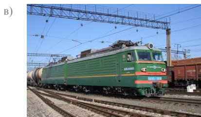
Рисунок 4.31 – Магистральные грузовые электровозы постоянного тока: а – восьмиосный двухсекционный; б – шестиосный односекционный; в – восьмиосный двухсекционный; г – восьмиосный двухсекционный с асинхронным тяговым двигателем
