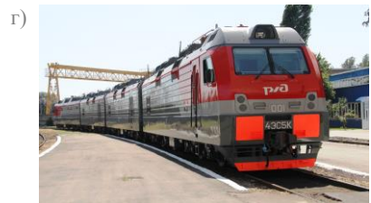
Рисунок 4.32 – Магистральные грузовые электровозы переменного тока: а – шестиосный односекционный; б – восьмиосный двухсекционный повышенной мощности; в – двенадцатиосный трехсекционный; г – шестнадцатиосный четырехсекционный
