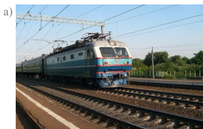
Рисунок 4.32 – Магистральные грузовые электровозы переменного тока: а – шестиосный односекционный; б – восьмиосный двухсекционный повышенной мощности; в – двенадцатиосный трехсекционный; г – шестнадцатиосный четырехсекционный
