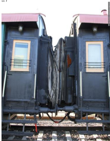
Рисунок 1.99 – Межвагонные переходы: а – в российских вагонах; б – в европейских
