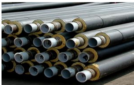
Рисунок 6.13 – Внешний вид труб с внутренним пенополиуретановым
