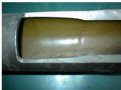
Рисунок 6.11 – Внутренне покрытие стальных труб
