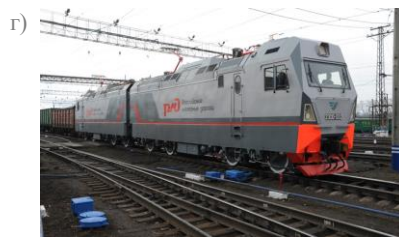
Рисунок 4.31 – Магистральные грузовые электровозы постоянного тока: а – восьмиосный двухсекционный; б – шестиосный односекционный; в – восьмиосный двухсекционный; г – восьмиосный двухсекционный с асинхронным тяговым двигателем
