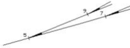
Рисунок 2.2 – Укладка стрелочных переводов 7 и 9 по схемам взаимного расположения относительно перевода 5
