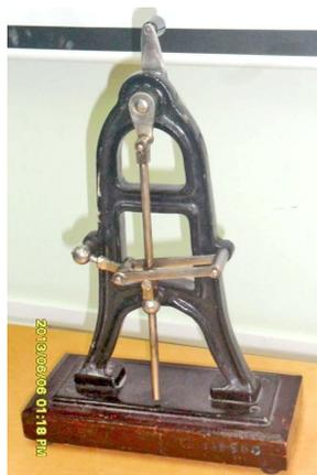
Рисунок 6 – Механизм с качающейся муфтой
