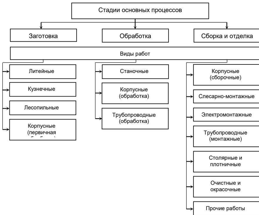
Рисунок 1.28 – Структура основных процессов и видов работ судоремонтных и судостроительных предприятий
