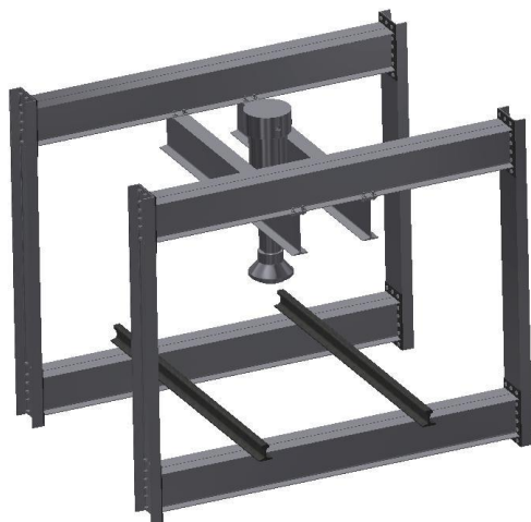
Рисунок 1 – Общий вид стенда для регулировки зазоров скользунов и прогиба рессорного подвешивания тележек пассажирских вагонов
