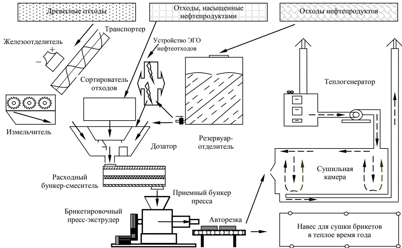
Рисунок 7. – Схема опытно-промышленной установки
