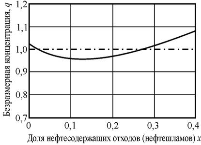
**Рисунок 5. – Кривая зависимости безразмерной концентрации  $q$  от доли нефтешламов  $x$  при мощности котла 0,5 МВт**
