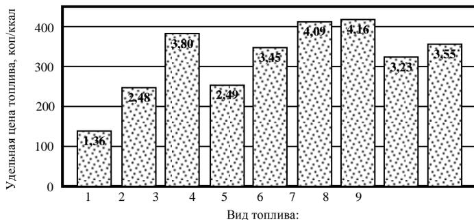
1 – полученное топливо «Марка-2» при  $w = 15\%$ ; 2 – дрова (кругляк) при  $w = 15\%$ ; 3 – дрова колотые при  $w = 15\%$ ; 4 – торфобрикет при  $w$  не более  $16\%$ ; 5 – топливный брикет типа *RUF* при  $w = 12\%$ ; 6 – топливный брикет типа *Pini Kei* при  $w = 9\%$ ; 7 – топливные гранулы при  $w = 7,7\%$ ; 8 – уголь бурый марки Б-2; 9 – уголь антрацит марки АМ
