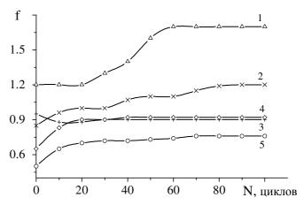
1 – исходная; 2 – с покрытием ПТФЭ; 3 – деформированная с покрытием ПТФЭ; 4 – обработанная в плазме + покрытие ПТФЭ; 5 – деформированная, обработанная в плазме + покрытие ПТФЭ
