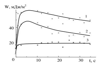
Рисунок 4. – Зависимость поверхностной энергии (1), ее полярной (2) и дисперсионной (3) компоненты пленки ПЭ от времени обработки пучком ионов азота
