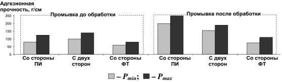
Рисунок 7. – Зависимость адгезионной прочности сварного соединения ПИ-Фт от варианта промывки пленки
