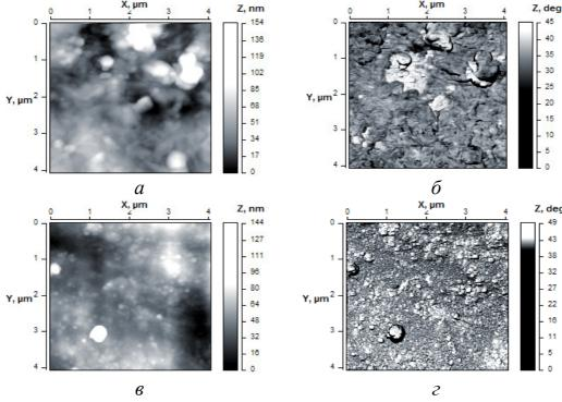
а, в – топография; б, г – фазовый контраст, после плазменной обработки в течение 0 (а, б), 20 мин (в, г) Рисунок 1. – АСМ-изображения поверхности пленок ПУ
