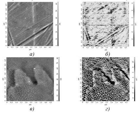
Рисунок 2. – АСМ-изображения топографии  $(a, \, b)$  и распределения потенциала поверхности  $(b, \, c)$  ПИ слоя пленки ПМФ–351 до  $(a, \, b)$  и после  $(b, \, c)$  обработки в течение 5 с в плазме НЧТР
