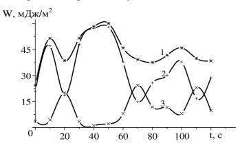
Рисунок 5. – Зависимость поверхностной энергии (1), ее полярной (2) и дисперсионной (3) составляющих, от времени обработки резины ионами азота
