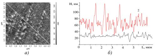
а – обработанная в плазме барьерного разряда в течение 30 с; б – сравнительный анализ профиля поверхности исходной (1) и обработанной в течение 60 с (2) пленок Рисунок 6. – АСМ-изображение поверхности и профиля сечения пленки ПМФ–351 со стороны ПИ
