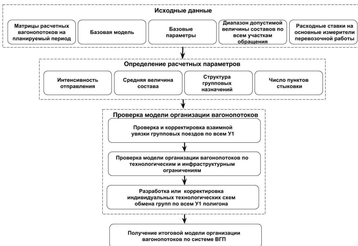
**Рисунок 7. – Общий алгоритм выполнения плановой корректировки базовой модели организации вагонопотоков по системе ВГП**
