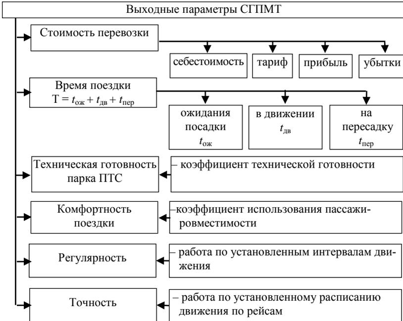
**Рисунок 1. – Выходные параметры СГПМТ**
