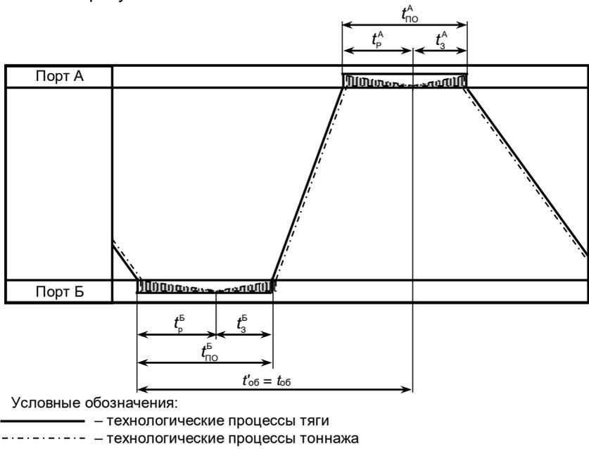
Рисунок 4.6 – Схема обслуживания состава с постоянным закреплением за ним толкача:
