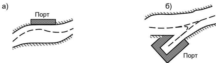
Рисунок 1.20 – Схемы расположения речных портов:
