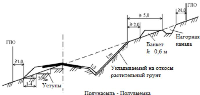
Рисунок 4.3 – Поперечный профиль «полунасыпь-полувыемка»
