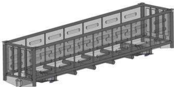
Рисунок 1 – Несущая конструкция полувагона из круглых труб, заполненных пеноалюминием
