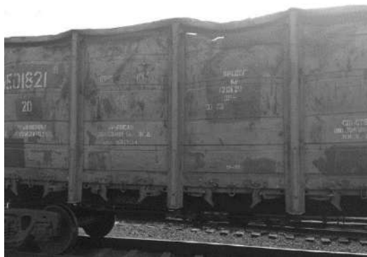
Рисунок 2 – Неисправная верхняя обвязка полувагона
