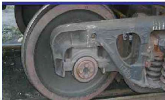
Рисунок 1 – Конструктивное исполнение адаптера (а) и его расположение в колесной паре (б)
