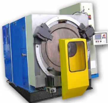
Рисунок 6.12 – Колесорасточной станок модели КРС2791М-Н1
