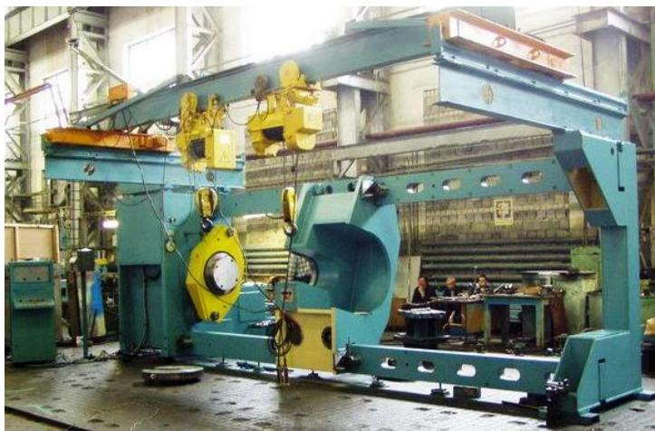
Рисунок 6.10 – Гидравлический пресс модели П6738
