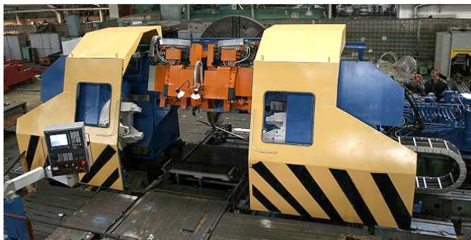
Рисунок 6.13 – Колесотокарный станок модели 1К836Ф3
