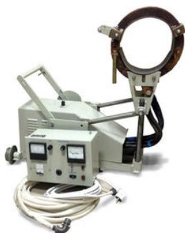
Рисунок 6.2 – Разъёмный дефектоскоп МД-13ПР
