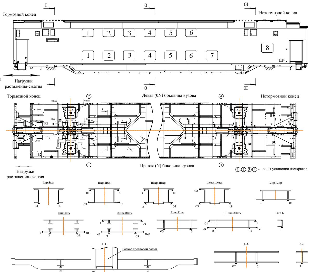
Рисунок 1 – Схемы расположения сечений и установки тензодатчиков
