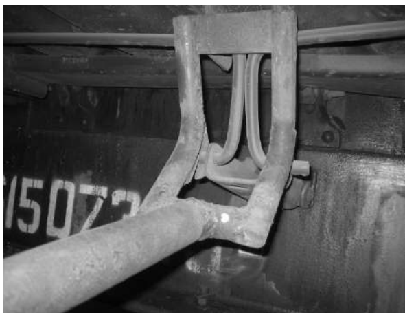
Рисунок 1 – Приспособление для снятия торсионов
