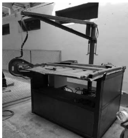
Рисунок 2 – Установка для клепки петель люка
