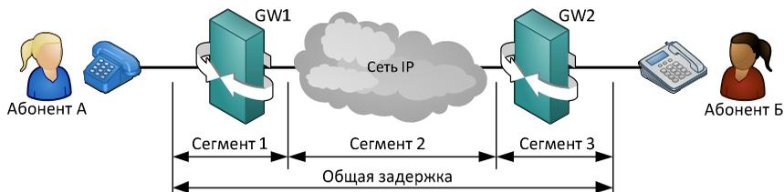
Рисунок 5.12 – Составные части задержки
