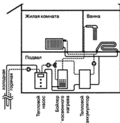
Рис. 30. Пример использования теплового насоса в доме
