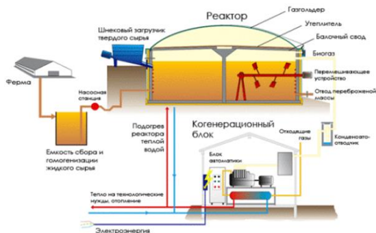
Рис. 12. Схема промышленной биогазовой установки
