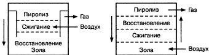
Рис. 9. Газификация способом нисходящего и восходящего потоков
