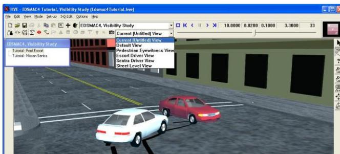
Рисунок 2.11 – Пример моделирования в программе реконструкции и анализа дорожно-транспортных происшествий EDCRASH
