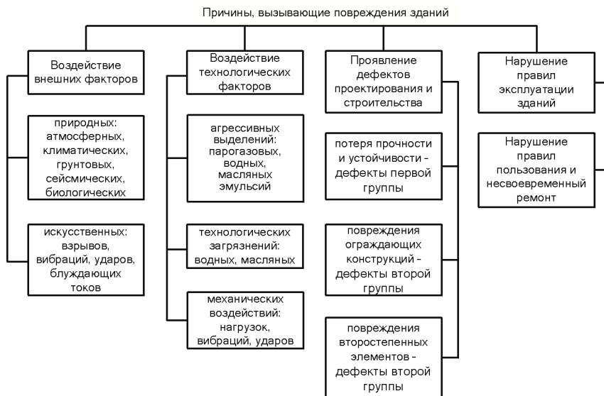
Рисунок 1.2 – Классификация причин повреждений зданий в процессе эксплуатации
