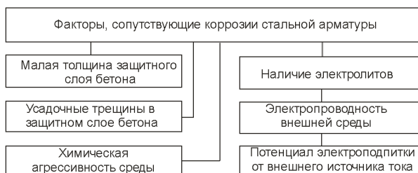
Рисунок 3.15 – Классификация факторов, сопутствующих коррозии стальной арматуры
