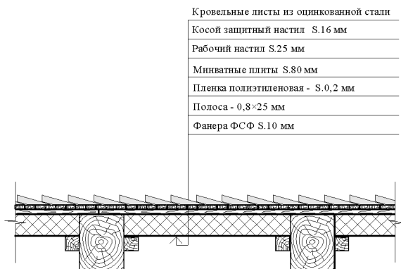
Рисунок 7.8 – Состав покрытия (проектный)
