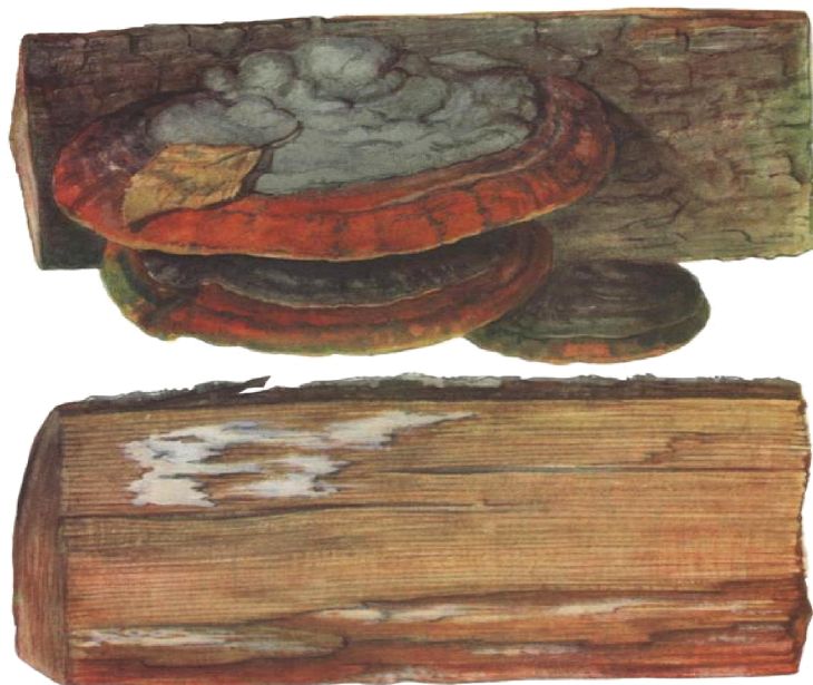
Рисунок 5.4 – Плодовые тела окаймленного трутовика Fomitopsis pinicola (Fr.) Karst. и вызванная им гниль ели
