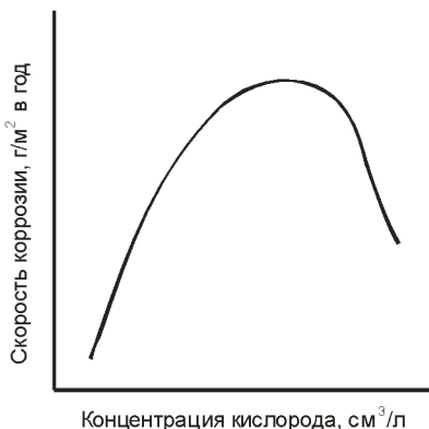
Рисунок 3.12 – Зависимость скорости коррозии от концентрации кислорода
