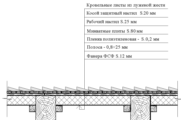
Рисунок 7.7 – Состав покрытия
