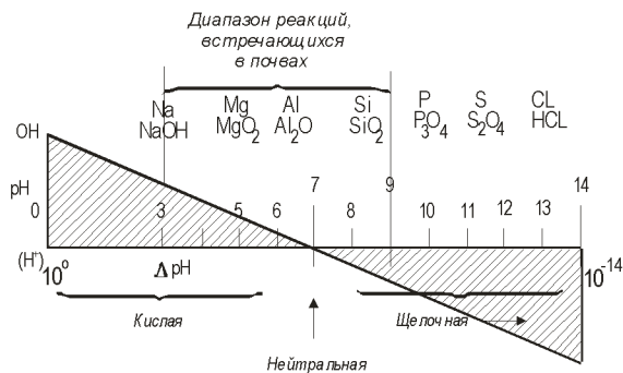
Рисунок 3.10 – Характеристика (рН) грунтовых вод и интенсивность коррозии металлов
