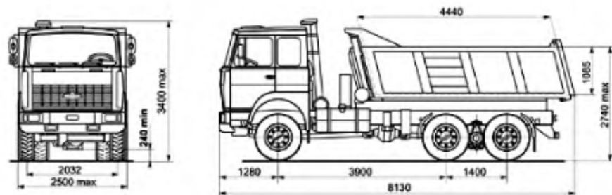
Рисунок 4.3 – Габаритные размеры автомобиля-самосвала
