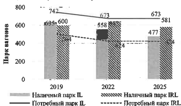
Рисунок 4 – Сравнение потребности и наличия вагонов локомотивной тяги для обеспечения пассажирских перевозок по видам сообщения
