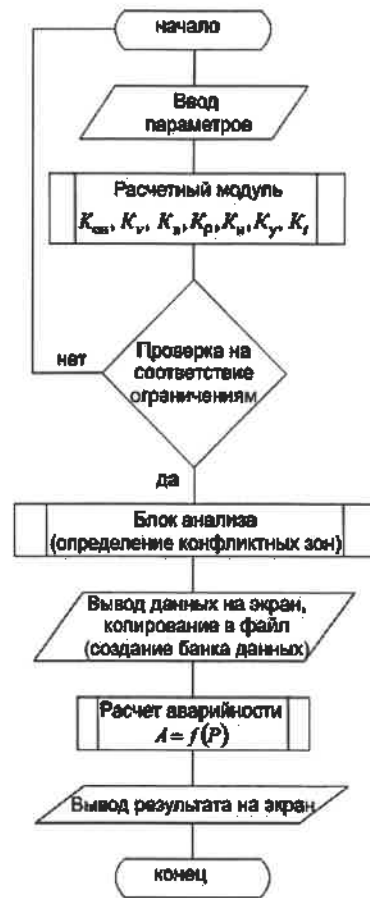
Рисунок 5 – Блок-схема модуля для определения потенциальной опасности в попутном потоке
