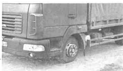
Рисунок 1 – Испытание шестигранной плитки нагрузкой автомобиля МАЗ-4371
