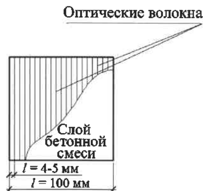
Рисунок 3 – Схема раскладки оптического волокна в светопроводящем слое (вид сверху) образцов-кубов 100×100×100 мм
