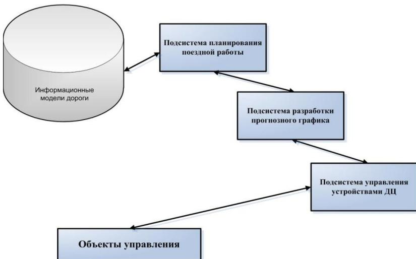
Рисунок 9.2 – Схема взаимодействия элементов комплексной системы планирования и управления поездной работой
