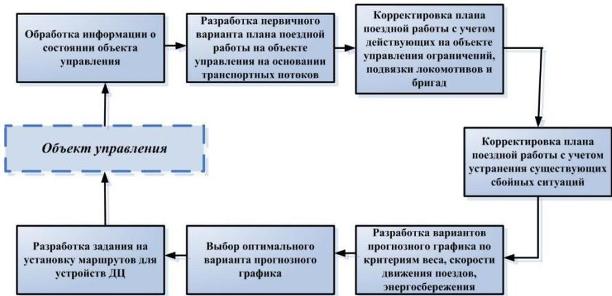
Рисунок 9.4 – Схема цикла формирования управленческих решений комплексной системы управления поездной работой дороги
