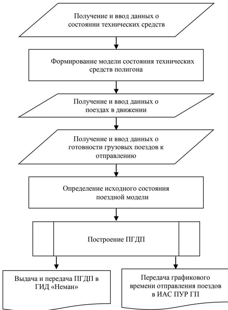
Рисунок 9.8 – Укрупненная схема разработки ПГДП
