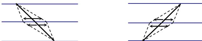
5 Создание, удаление, изменение остановки с параллельным переносом соответствующей части нитки поезда:
