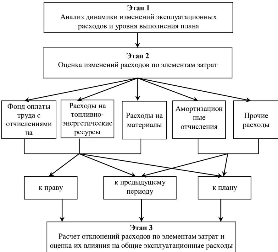
Рисунок 10.3 – Схема анализа эксплуатационных расходов дороги
