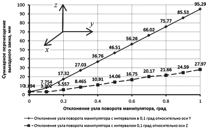
Рисунок 8 – Изменение суммарного перемещения выходного звена от отклонения узла поворота по отношению к осям X и Y
