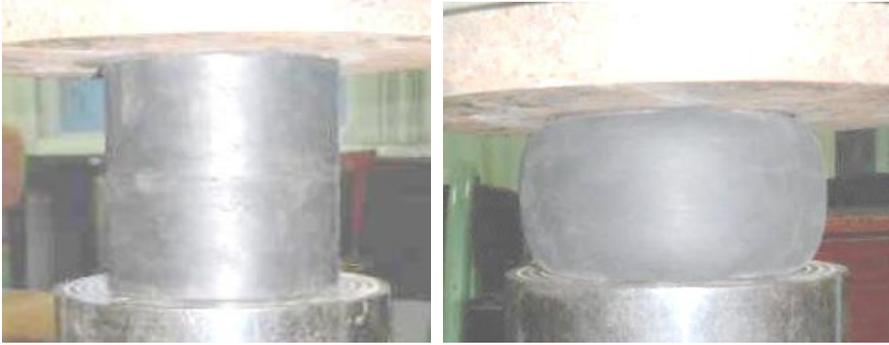
Рисунок 1 – Образец до испытания. Сжатие резинометаллического образца.
