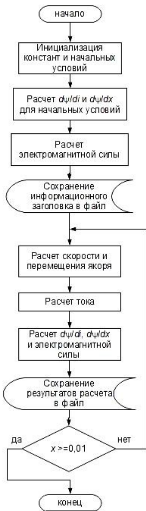
Рисунок 4 – Блок-схема алгоритма моделирования движения якоря электромагнита
