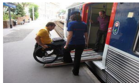
Рисунок 3 – Специальное оборудование поезда для беспрепятственного движения людей с ограниченными возможностями
