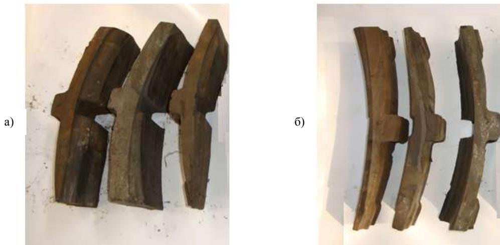
Рисунок 2 – Экземпляры изношенных тормозных колодок грузовых вагонов депо Основа:
