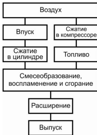
Рисунок 6.7 – Схема рабочего цикла ДВС с внутренним смесеобразованием и пневматическим впрыском топлива
