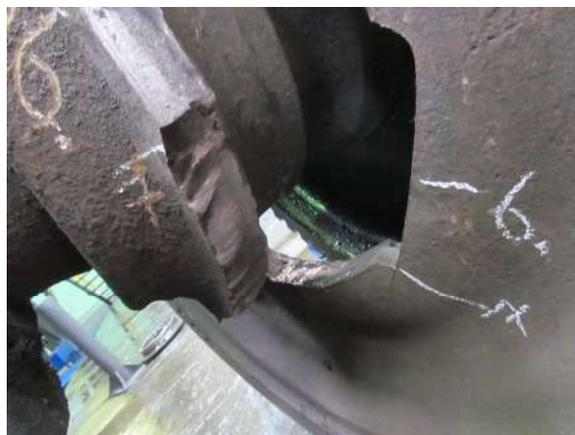
Рисунок 2 – Напряженно-деформированное состояние колеса и фрагмент излома колесного центра
