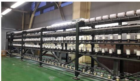
Рисунок 7 – Машина для производства латексных оплетенных нитей
