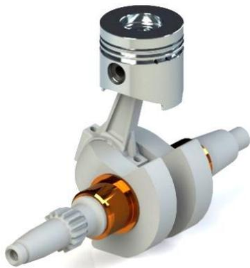
Рисунок 2 – Цифровая 3D-модель кривошипно-шатунного механизма
