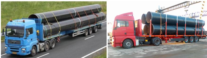
Рисунок 1 – Размещение и крепление труб на автопоезде
