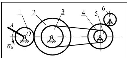
20. В механизме, изображенном на рисунке, рукоятка  $OA$  вращается с частотой  $n_0$ . Определить, при каком соотношении радиусов  $R_1/R_2$  частота вращения колеса 6 будет больше частоты вращения рукоятки в 5 раз. Известно:  $R_2 = 0,6$  м,  $R_3 = 0,4$  м,  $R_4 = 0,2$  м,  $R_5 = 0,5$  м.
