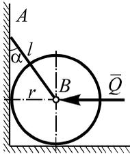
Размеры  $r$  и  $l$  могут быть такими, что каток будет касаться стены, и поэтому его нельзя вывести из равновесия силой  $Q$ . Для этого случая из геометрии системы получаем:
