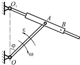
Определить скорость и ускорение точки  $B$  кулисного камня механизма в положении, определяемом углом  $\varphi$ , если длина кривошипа  $OA = r$ , расстояние между осями вращения кривошипа и кулисы  $O_1O = r$  и  $AB = r/2$ . Угловая скорость кривошипа  $\omega$ , его угловое ускорение  $\varepsilon$ .
