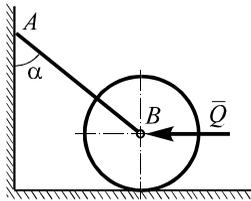
Рукоятка катка, шарнирно соединенная с его осью, опирается своим концом  $A$  на вертикальную гладкую стенку. Вес рукоятки равен  $P$ , ее длина  $l$ , вес катка также равен  $P$ , его радиус  $r$ . В точке  $B$  к катку приложена горизонтальная сила  $Q = 2P$ . При каких значениях угла  $\alpha$  возможно равновесие системы, если коэффициент трения скольжения между катком и горизонтальной плоскостью равен  $f$ , а коэффициент трения качения равен  $\delta$ .
