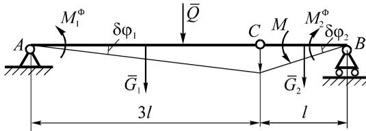
Для определения углового ускорения стержня  $AC$  запишем общее уравнение динамики материальной системы
