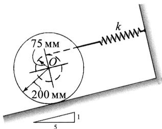
29. Катушка массой 10 кг с радиусом инерции относительно оси  $O$ , равным 125 мм, связана с пружиной с коэффициентом жесткости  $k = 600$  Н/м с помощью каната, обмотанного вокруг внутреннего радиуса. Учитывая, что катушка выходит из состояния покоя при растяжении пружины 225 мм, рассчитать максимальную скорость центра  $O$  при дальнейшем движении. Катушка катится без проскальзывания.
