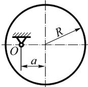
24. Однородный диск массой 0,6m вращается в вертикальной плоскости под действием силы тяжести относительно оси  $O$ , перпендикулярной плоскости диска. Определить угловое ускорение диска в указанном на рисунке положении, если радиус диска  $R = 0,64$  м,  $a = 3R/4$ .
