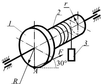
28. Ступенчатый вал массы  $m = 20$  кг с радиусом инерции 10 см начинает движение из состояния покоя под действием силы  $F = 10$  Н, приложенной в плоскости диска 1 к точке  $A$  обода.  $R = 25$  см, сила тяжести груза  $G = 15$  Н,  $r = 12$  см. Найти время, за которое вал сделает один полный оборот.
