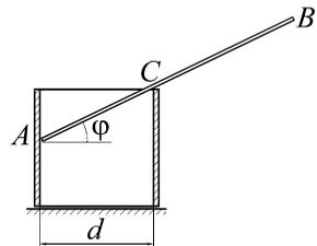
Определить, при каком значении угла  $\varphi$  и наименьшем весе  $Q$  стержня он может опрокинуть цилиндр, а также реакции в точках  $A$  и  $C$  в начальный момент опрокидывания. Найти отношение  $d$  к  $l$ , при котором возможно равновесие стержня.
