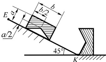
27. Однородная пластина массой  $m = \sqrt{3}$  кг с центром тяжести в точке  $C$  начала двигаться из состояния покоя по наклонной гладкой плоскости. В начале движения левая опора пластины находилась в точке  $E$ . Определить работу силы тяжести пластины, если, достигнув точки  $K$ , она перевернулась и легла на правый бок. Известно:  $\alpha = 40^\circ$ ,  $b = 2a\sqrt{3}$ ,  $EK = 10a$ .
