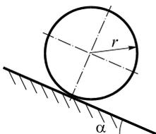
26. Сплошной однородный диск массой  $m$  и радиусом  $r$ , расположен на шероховатой наклонной поверхности. Коэффициент трения с поверхностью 0,4. Определить угол наклона поверхности, при котором угловое ускорение диска составляет  $\varepsilon = g/r\sqrt{3}$ . Сопротивлением качению пренебречь.
