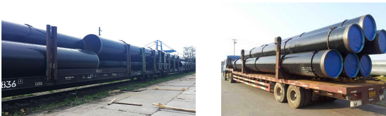
Рисунок 1 – Перевозка труб на железнодорожном и автомобильном транспорте
