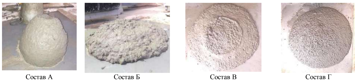
Рисунок 3 – Бетонная смесь со стальной проволочной фиброй анкерного профиля
