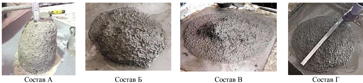
Рисунок 5 – Бетонная смесь со стальной фиброй волнистого профиля
