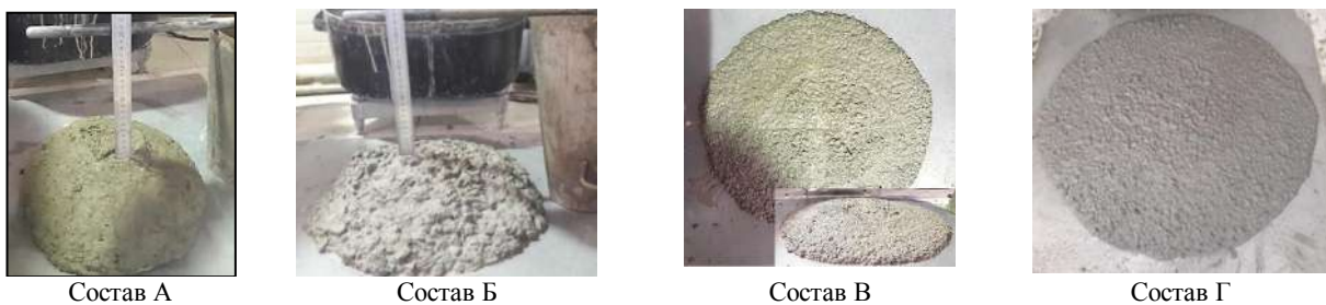
Рисунок 4 – Бетонная смесь с полимерной фиброй волнистого профиля
