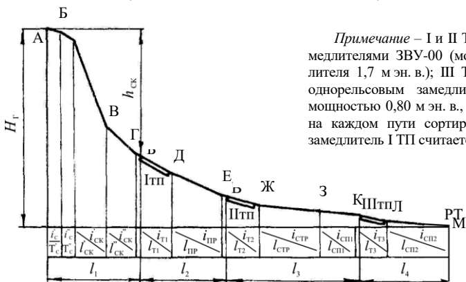
Рисунок 6.9 – Схема продольного профиля спусковой части горки и сортировочных путей до расчетной точки
