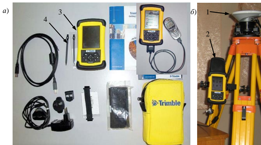
Рисунок 8.14 – КПК Recon (а) и интегрированная одночастотная GPS-система определения координат на местности Trimble R3 в сборе (б)
