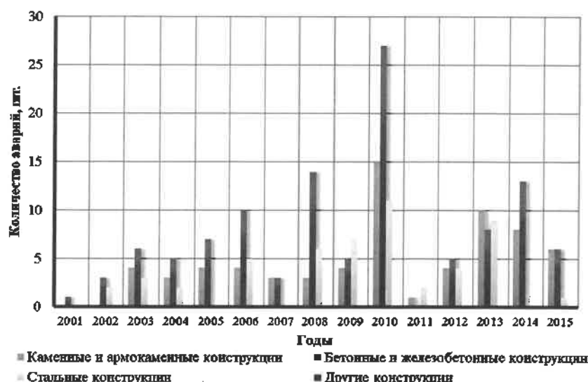
Рисунок 2 – Анализ аварийности строительных конструкций производственных зданий в 2001–2015 гг. (по материалам конструкций)
