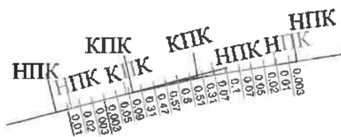
Рисунок 1 – Определение величин несовпадения кривых при приведении существующей кривой в проектное положение
