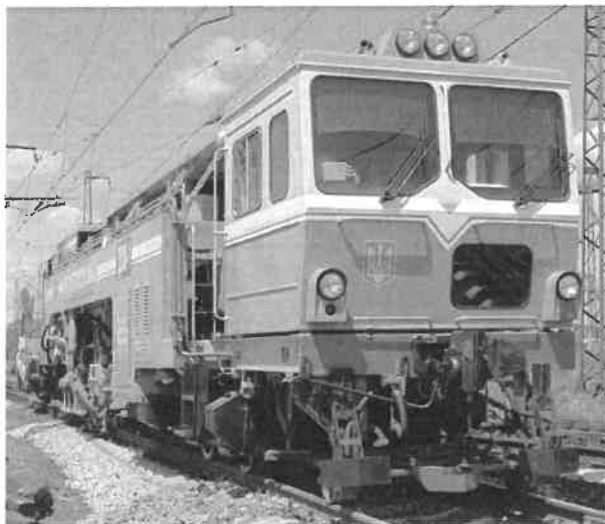
Рисунок 2 – Машина ВПР-02 с установленной системой «Стрела»
