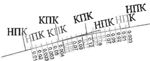
Рисунок 3 – Определение величин несовпадения кривых (существующей относительно расчетной № 2)
