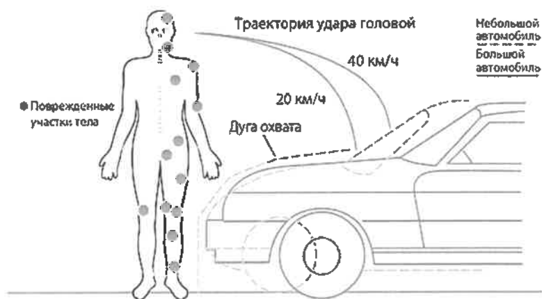
Рисунок 1 – Повреждаемые участки тела пешехода при столкновении с транспортным средством
