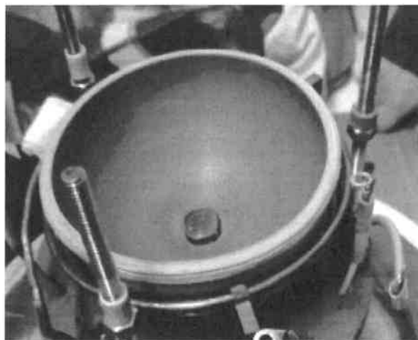
Рисунок 1 – Газоразрядная камера из материала системы кремнийорганический эластомер – керамика в составе макета ВЧИД
