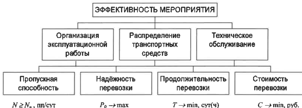
Рисунок 2 – Структурная схема оценки эффективности мероприятий по повышению пропускной способности
